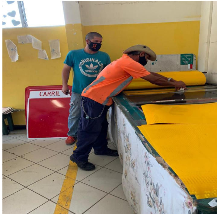
Figura 7. Capacitación sobre elaboración de señales de tránsito verticales al personal operativo de Mantenimiento de Calles y Caminos en el taller de la Dirección General de Ingeniería de Tránsito (MOPT). Fuente: Autoría propia.
