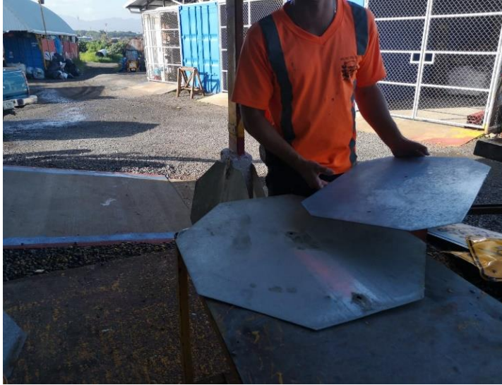
Figura 1. Elaboración señales de tránsito con material reciclable del personal operativo de Mantenimiento de Calles y Caminos. Fuente: Jimmy Sánchez Benavides, Inspector Vial, Unidad Técnica de Gestión Vial.
